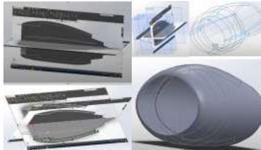
Gambar 2. Contoh Reverse Engineering Engine Nacelle CFM56-7B menggunakan orthographic reference pada software SolidWork.
