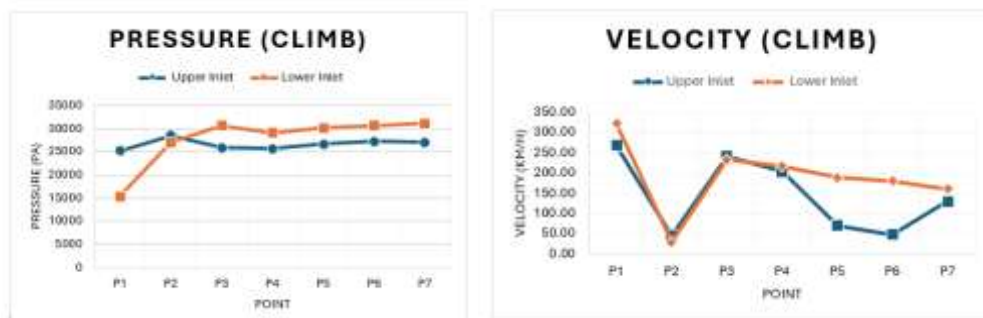
Gambar 4. Grafik data pressure dan velocity pada inlet B737-800 sepanjang titik P1 hingga P7 pada kondisi Climb
