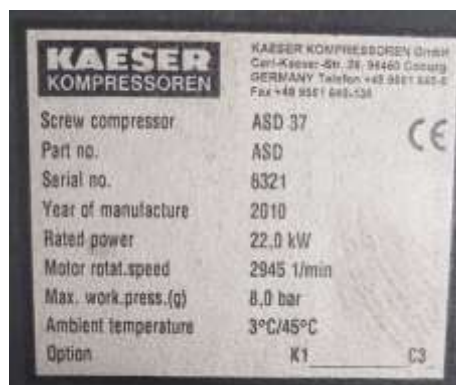
Gambar 7. Spesifikasi Kompresor Hangar PT. Mulya Sejahtera Technology
