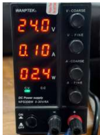
Gambar 15. Hasil Arus Yang Dihasilkan Dengan 1 lampu
