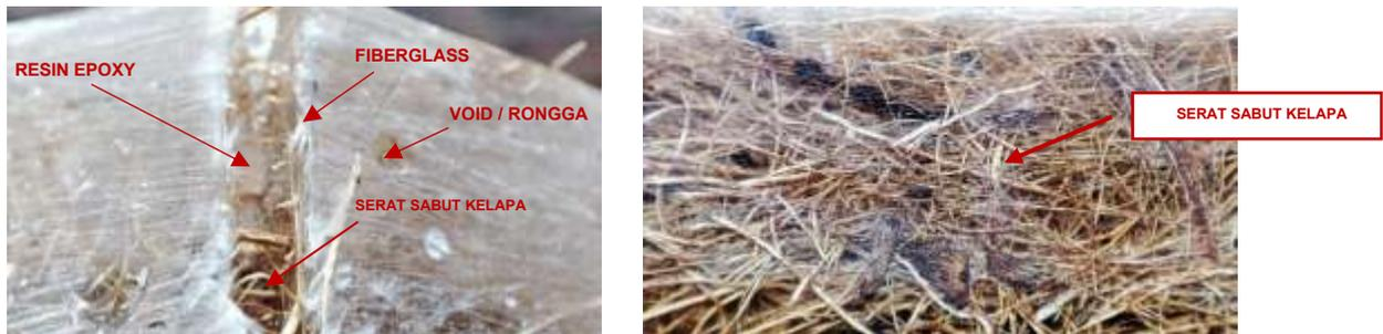
Gambar 4. Hasil Foto Makro Pada Material Komposit Hybrid
