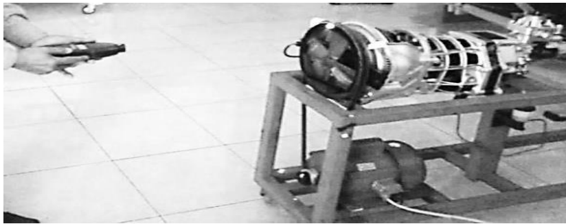
Gambar 5. Pengukuran kecepatan rpm roda puli flywheel beban transmisi netral
