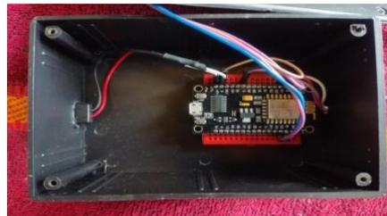
**Gambar 4.** Mikrokontroler Esp8266
