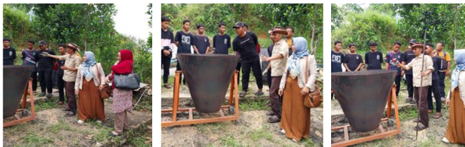
Gambar 5. Alat Kontiki Kiln untuk Proses Pirolisis Limbah Biomassa.
