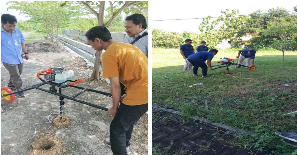
**Gambar 5** Uji Coba Mesin Bor Tanah.
