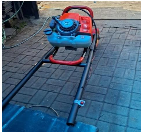
Gambar 2 Mesin Bor Tanah Tipe EA 630
