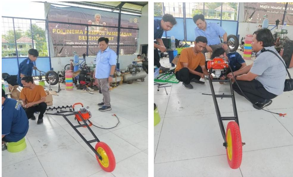
**Gambar 4** Perakitan Mesin Bor Tanah.
