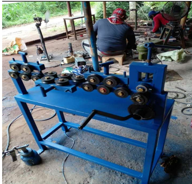
Gambar 2. Mesin pelurus kawat
