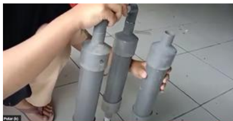
Gambar 4. Proses penyatuan tiap bagian pipa
