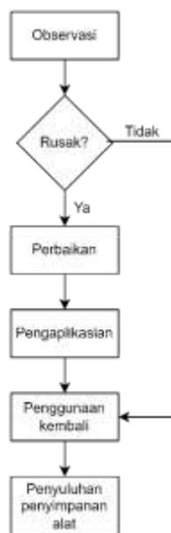
**Gambar 1. Diagram Alir Prosedur Perbaikan Alat**
