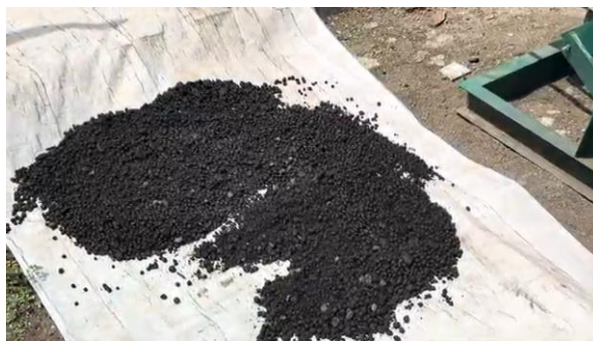
Gambar 5. Polychar yang masih basah dikeringkan di bawah sinar matahari.
