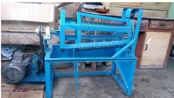
**Gambar 11.** Mesin Penyaringan
