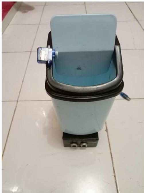
**Gambar 10. Prototipe dalam keadaan mendeteksi orang dengan jarak <20cm tampak depan**
