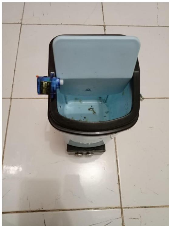
**Gambar 11. Prototipe dalam keadaan mendeteksi orang dengan jarak <20cm tampak atas**
