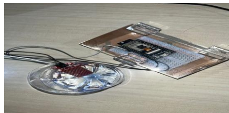
Gambar 5. Proses Pengecekan Ketinggian Air
