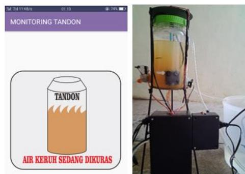
Gambar 4. Pengujian sensor kekeruhan air
