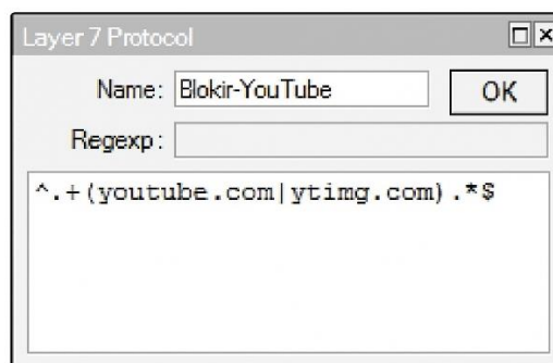
Gambar 3. Contoh Script Layer 7 Protocol untuk Blokir YouTube
