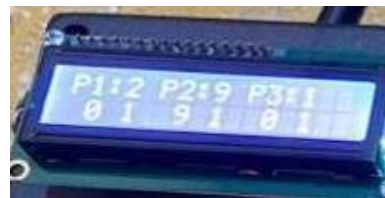
Gambar 13. Pengujian LCD perhitungan ritase
