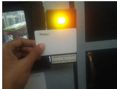
Gambar 10. Implementasi Kontrol RFID dan tag RFID
