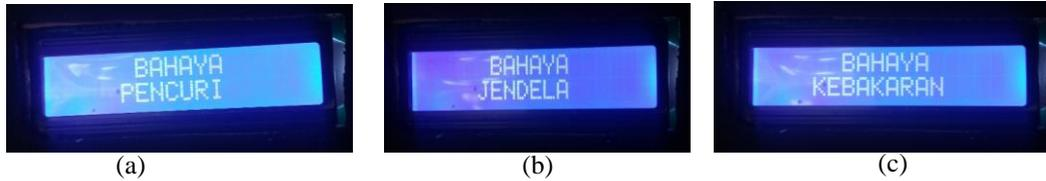
Gambar 12. (a) Keluaran LCD Sensor PIR. (b) Keluaran LCD Sensor Gerak. (c) Keluaran LCD Sensor Asap.
